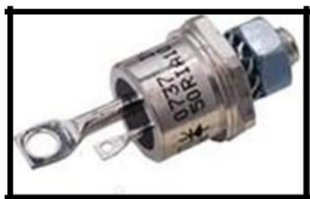
Figura 10. Disipador ánodo (A) y cátodo (K). Fuente: Recuperado de http://mexico.newark.com/vishay-semiconductor/vs-50ria60/scr-thyristor-50a-600v
