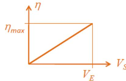
*η disminuye con la caída de tensión entre entrada y salida*
