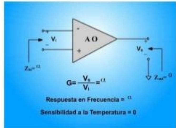
Dependiendo del montaje se pueden realizar diferentes operaciones
