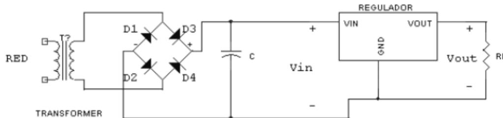
Si has seguido las explicaciones hasta ahora no te costará trabajo distinguir el transformador, el puente rectificador y el filtro con condensador a la entrada. Suele ser muy normal ajustar el condensador según la regla del 10%, Si no sabes como repasa el filtro con condensador a la entrada.
