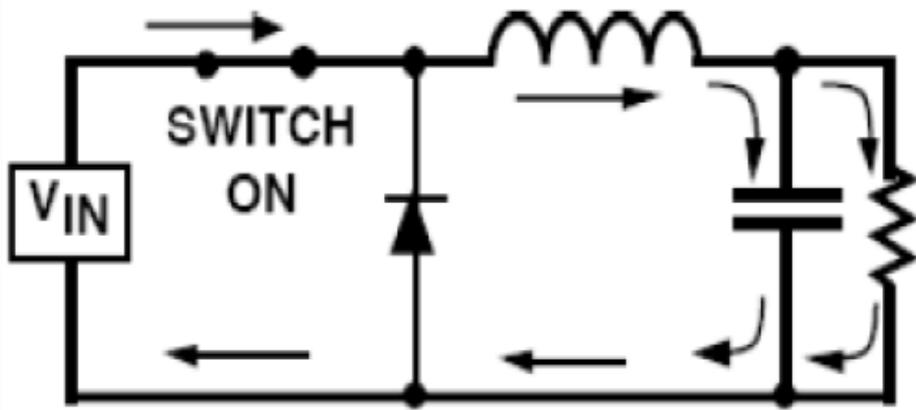
$$i_l = \frac{(V_{in} - V_{out}) \times T_{in}}{L} + i_{ini}$$
