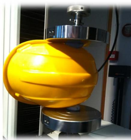
Figura 13 Ensayo de compresión transversal
