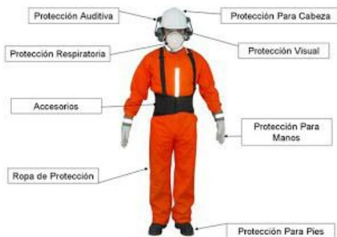
Fig. 1 Elementos de protección personal
